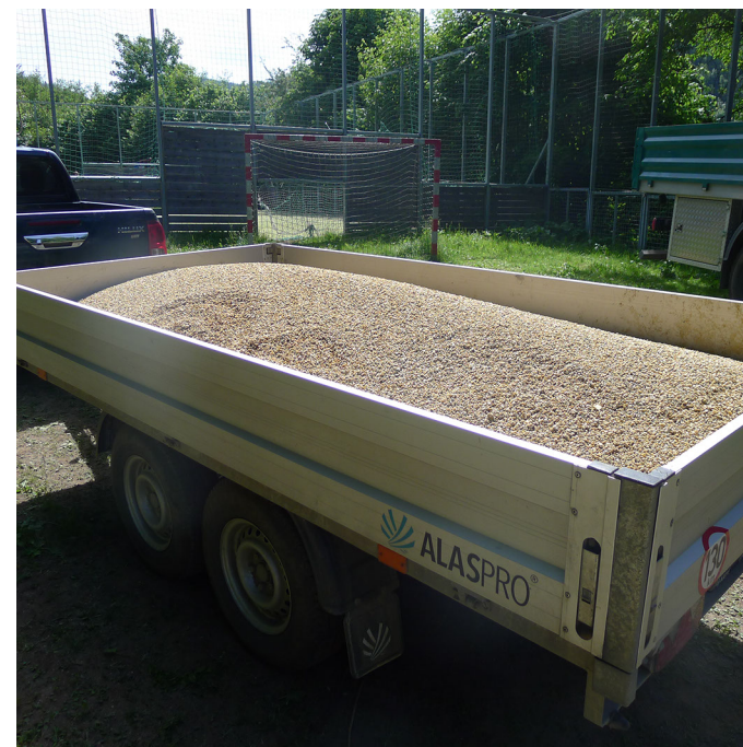
Obr. 10 Obsyp - tříděný kačírek 4-8
