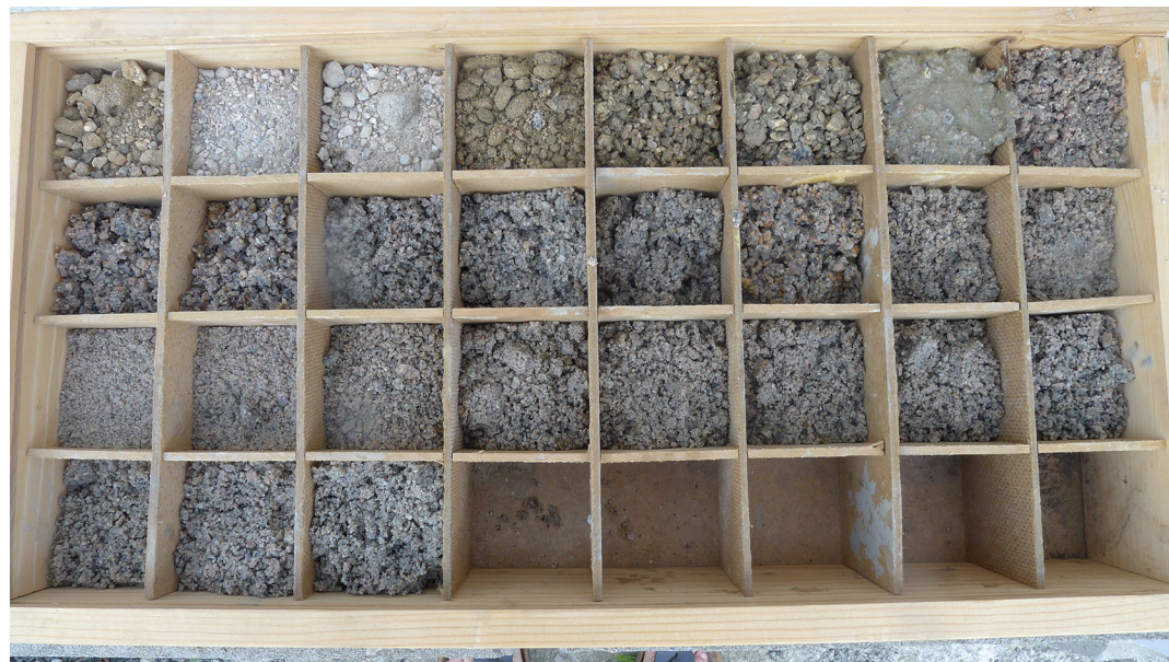
Obr. 16 Vrtné jádro - 3 m intervaly
